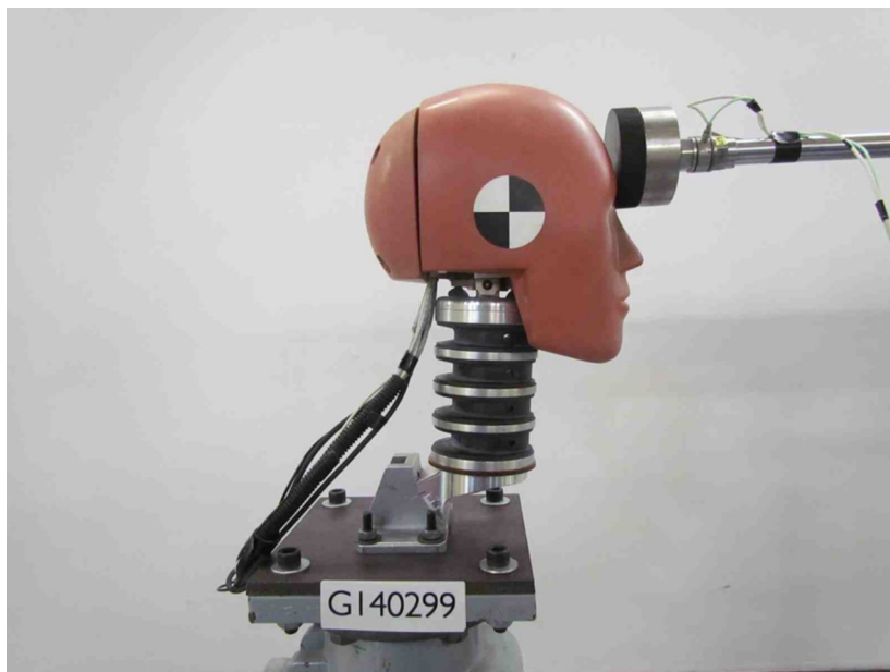
Figura 2.10: Configuración del Hybrid III para impactos frontales
